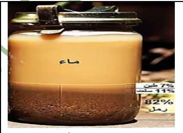
عينة مخبرية من تربة أرض نبييل بعد خلطها بالماء
