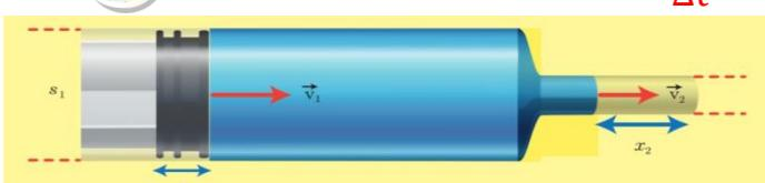
**سؤال نظري (18) استنتاج العلاقة الرياضية المعتبرة عن معادلة الاستمرارية وذلك من أجل سائل يتحرك داخل أنبوب ويملأه****وجريانه فيه مستمراً وله مقطعان مختلفان  $S_1, S_2$** **معدل التدفق الحجمي (معدل الضخ) ثابت :**  $Q' = \frac{V}{\Delta t} = const$ **معدل التدفق الحجمي للسائل عبر المقطع  $S_1$  يساوي معدل التدفق الحجمي للسائل عبر المقطع  $S_2$**
